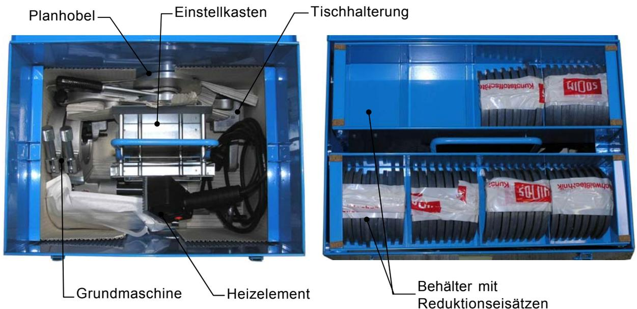
Unterbringung der einzelnen Elemente im Stahlblechtragekasten.
