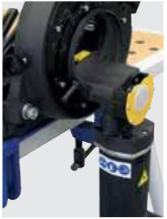
Inklusive zweite Sägeblattaufnahme zum Heraustrennen von Rohrbögen
