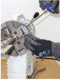
Werkzeug-Schnellspannsystem QTC® (Quick-Tool-Change)
