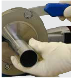
Schnellwechselsystem für Werkzeuge, Spannschalen und Rohre
