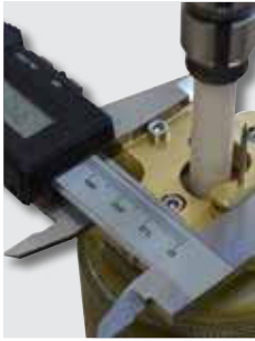
Einfache und präzise Einstellung der Elektrodenposition
