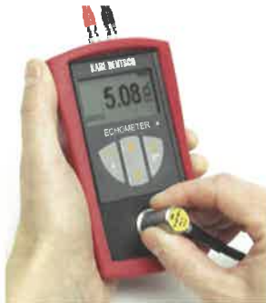
Bild 5: Kalibrieren auf dem eingebauten 5-mm-Kalibrierblock
