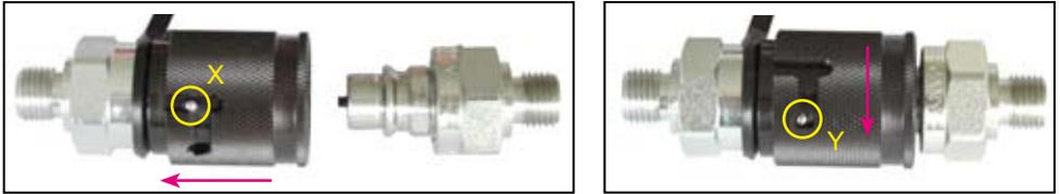
Vor dem Kuppeln Staubschutzkappen abnehmen, dann Verriegelungshülse der Muffe (Position X) zurückziehen und halten. Nippel und Muffe zusammenstecken und die Verriegelungshülse loslassen. Abschließend die Verriegelungshülse in Position Y drehen. Die Verbindung ist nun hergestellt und gesichert. Das Entkuppeln erfolgt in umgekehrter Reihenfolge.
