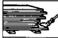
12. Verbinden Sie Klemmen niemals direkt mit dem Kranhaken. Verwenden Sie grundsätzlich eine Kettenschlinge zwischen dem Kranhaken und der Klemme, um eine Beeinträchtigung der Klemmenfunktion zu vermeiden und sicherzustellen, daß die Klemme stets ihre richtige Lage auf der Stahlplatte beibehält.
