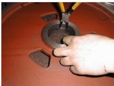
7. Legen Sie den Sicherungsring in das Loch an dem Rad ein.
