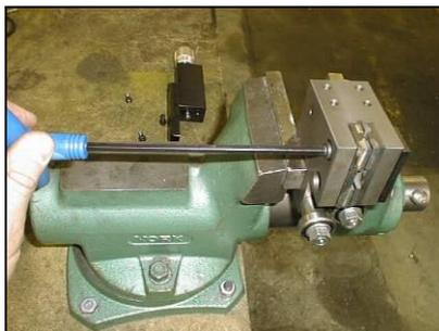
3. Schrauben Sie die Befestigungsschrauben an den Hartmetallführungen
