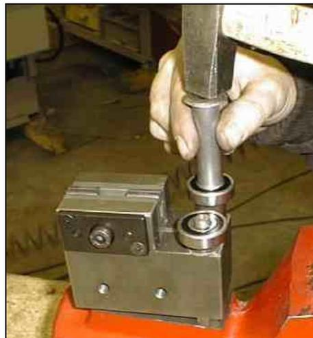
11. Setzen Sie beide Exzenter auf die Bandführungsklotzen.
