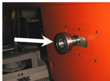
6. Setzen Sie das Lager auf die Welle und schieben Sie das bis zum Sicherungsring. Dann setzen Sie den Distanzring auf die Welle und schieben Sie ihn bis zum Lager..
