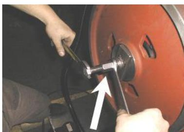
5. In das Loch in der Welle schrauben Sie den Aufzieher. Durch Festziehen der Mutter schieben Sie das Antriebsrad auf die Welle.
