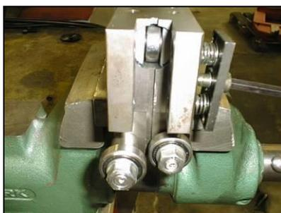
6. Legen Sie die neue Hartmetallführung ein und schrauben Sie diese fest.
