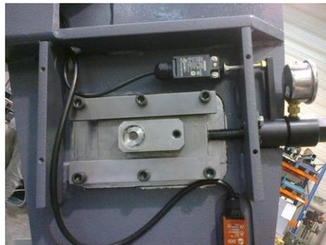
Die Einstellung des Endschalters der Bandspannungskontrolle sollte nach jedem Sägebandwechsel kontrolliert werden. Ist der Endschalter nicht korrekt eingestellt, so kann das Sägeband entweder zuwenig oder zuviel gespannt werden.
