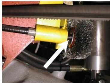
2. Lösen Sie die Mutter an der Spänbürste, ziehen Sie die Spänbürste herunter, setzen Sie die neue Spänbürste an, und ziehen Sie die Mutter wieder fest.
