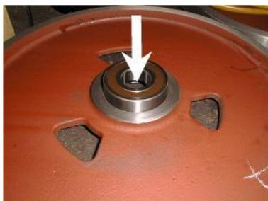
8. Legen Sie das Lager in das Loch an dem Rad ein schieben Sie das bis zum Sicherungsring.
