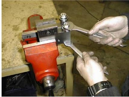
15. Mit zwei Schlüsseln schrauben Sie die Sicherungsmuttern auf Exzenter.
