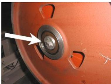
11. Sichern Sie das Umlenkrad mit der Scheibe und Schraube.
