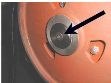
2. Schrauben Sie die Schraube heraus und entfernen Sie die Scheibe.
