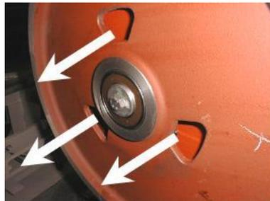
3. Setzen Sie einen Abzieher auf das Umlenkrad und ziehen Sie dieses vorsichtig von der Welle ab. Sollte das untere Lager des Umlenkrades auf der Welle bleiben, so ziehen Sie dieses mit einem Abzieher von der Welle ab..
