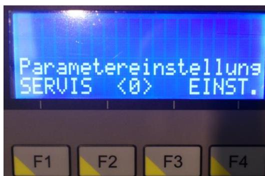
Betätigung und Bewegung bei der SERVICE-Einstellung ist mit Hilfe der Funktionstasten **F1 - F4** möglich
