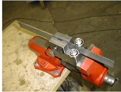
16. Legen Sie nun ein Reststück eines Sägebandes (ca. 15-20cm) in den Führungsklotz ein
