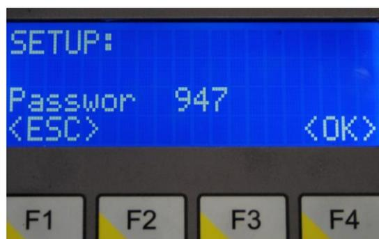
Betätigung und Bewegung bei der SERVICE-Einstellung ist mit Hilfe der Funktionstasten **F1 - F4** möglich.
