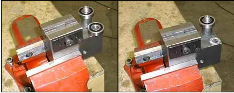
9. Tauschen Sie beide abgenutzte Lager, bzw. auch andere abgenutzte Teile, aus.
