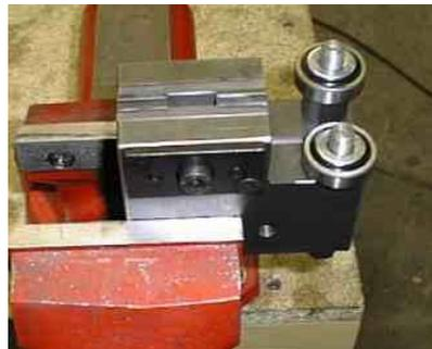
7. Ziehen Sie nun beide Führungsrollen von den Exzentern ab
