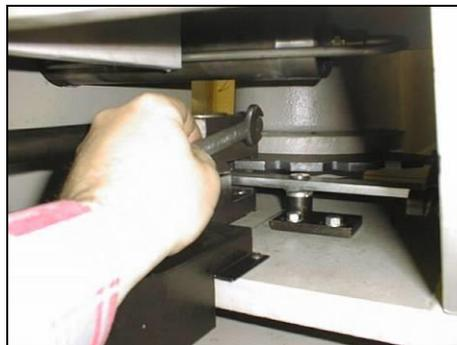
1. Lockern Sie die Befestigungsschraube des Klemmhebels, bis dieser bewegt werden kann
