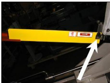
3. Demontieren Sie nun das linke Schutzblech des Sägebandes ecken
