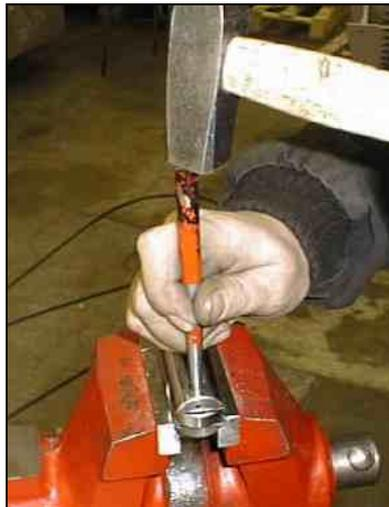
Spannen Sie die Halterung in Schraubstock
