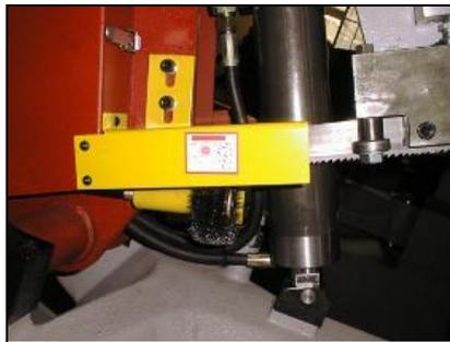
**Die Maschine kann erst wieder in Betrieb gesetzt werden, wenn die Sägebandschutzabdeckung geschlossen ist!**
