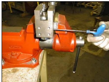
Legen Sie die komplettierte Halterung in den Führungsklotz ein, und befestigen Sie die mit Hilfe von dem Wurm und Inbusschlüssel
