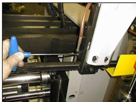
Montieren Sie den Klotz auf die Führungsklotzhalterung, befestigen Sie die Druckregulierung und schließen Sie die Kühlsteuerung an
