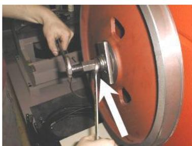
10. Das Umlenkrad ziehen Sie mit dem Aufzieher auf die Welle.
