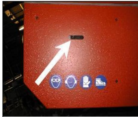
Der Sägebandlauf wird mit der Einstellschraube eingestellt.
