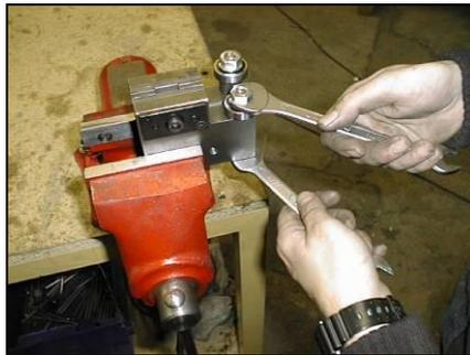
5. Spannen Sie den Führungsklotz in einen Schraubstock (Demontieren Sie nun beide Befestigungsschrauben der Exzenter)
