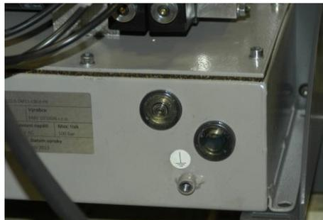
Wenn es notig ist, fullen Sie ein Hydraulikol nach. Bei dem Nachfullen verwenden Sie immer einen Filter (10 m oder besser). Vermeiden Sie damit eine Verschmutzung des Hydrauliksystems und daraus folgende Storungen.
