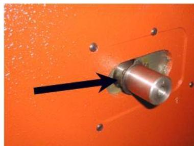
5. Säubern Sie die Welle und fetten Sie die ein. Setzen Sie den Sicherungsring auf die Welle.
