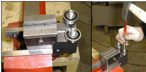
8. Schlagen Sie die Exzenter mit Hilfe von Anschlag aus den Lagern.
