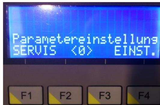
Durch Betätigung der Funktionstaste **F2** stellen Sie die Winkelanzeige an der Konsole auf Null.
