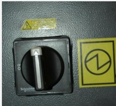
2. Schalten Sie die **Sicherheitsschaltung** ein ( position **3** ) am Bedienpult der Bandsäge
