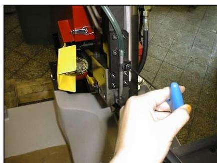
2. Spannen Sie den Fuhrungsklotz in einen Schraubstock. Losen Sie die Befestigungsschrauben beider Hartmetallfuhrungen und entfernen Sie diese.
