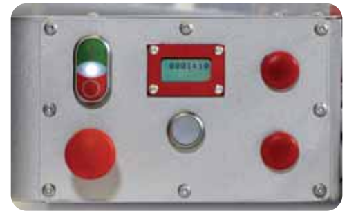
Bedientableau am ROBOT mit Betriebsstundenanzeige und NOT AUS Operating panel with service meter and Emergency Stop
