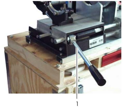
1. Grundmaschine (7) und Stahlrohr-Untergestell (4) auspacken.
