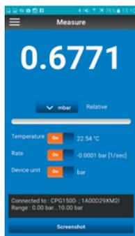
Über die App „myWIKa device“ und die WIKa-Wireless-Verbindung lässt sich das CPG1500 per Handy bequem für Kalibrier- und Log-Aufgaben konfigurieren. Während der Druckmessung wird der Wert in der benötigten Einheit direkt auf dem Handy angezeigt.
