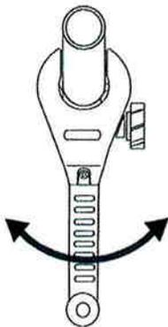
5) Drücken Sie beide Klauen nach unten, um die Ratschenfunktion des Drehkopfs auszuschalten. Move both claw pins down to make rotary head free from ratcheting function.
