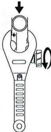
3) Drücken Sie die Druckrolle gegen das eingelegte Rohr und drehen Sie den Kopf mit dem Uhrzeigersinn, um das Rädchen zuzustellen. Attach the roller onto the pipe, turn knob cw to feed the cutting wheel onto the pipe.
