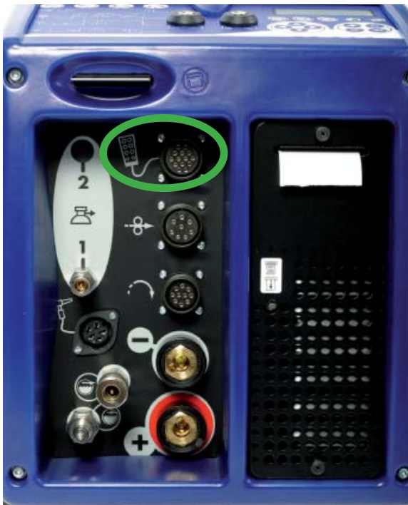
Abb. 4.6 - Anschluß der Fernbedienung an die PS 164-2
