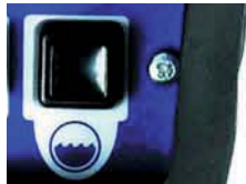
Abb. 5.4 - Taster 'Kühlmittelkreislauf' Kühlmittelpumpe einschalten
