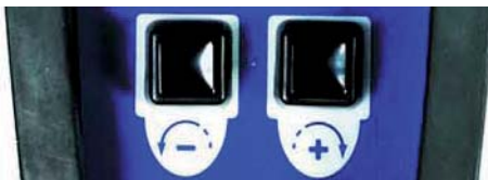
Abb. 5.1 - Symbole der Tasten zur Brennerpositionierung mit der Fernbedienung
