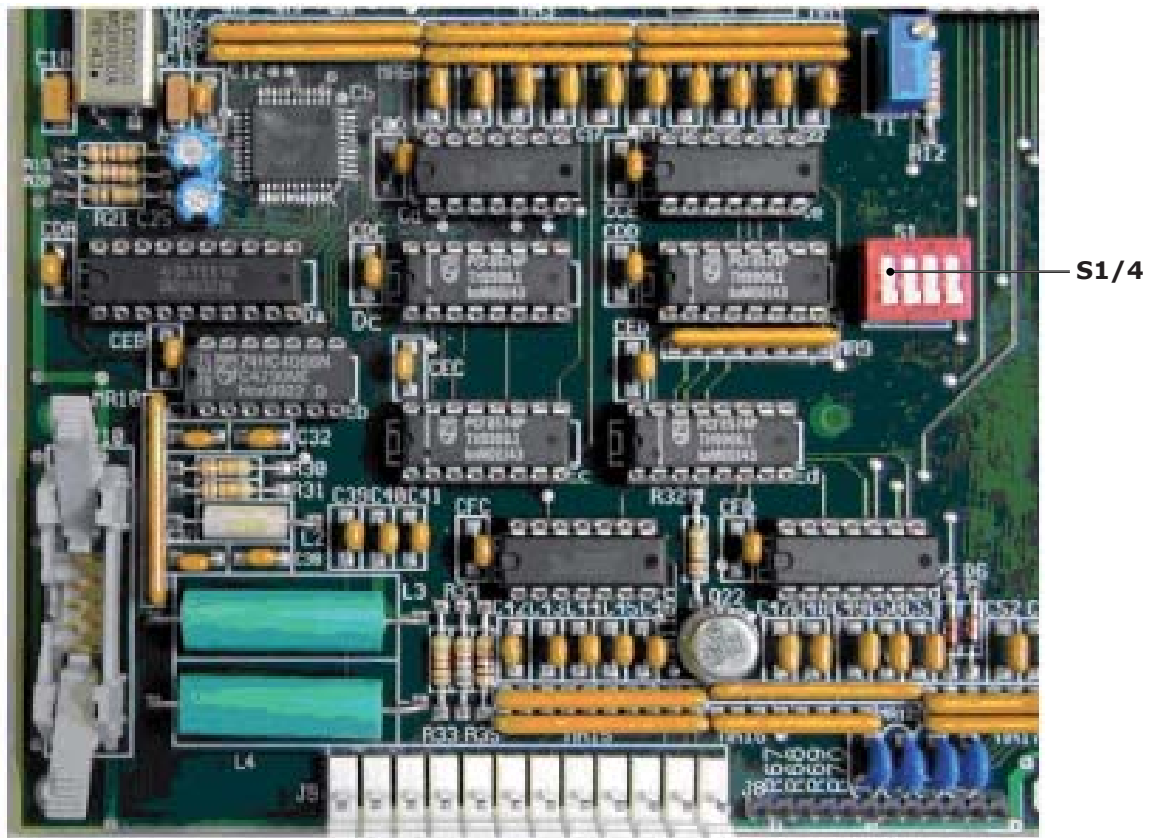
Abb. 6.2 - Dip-Schalter S1-4 auf der Karte 21700634 «Ablaufschema» in der Stellung 'CLOSED'
