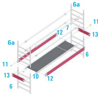
1. Oberste Standleitern 6, 6a aufstecken und mit Federsteckern 11 sichern. In die von oben 5. Sprosse eine Durchstiegsbrücke 10 einhängen.
