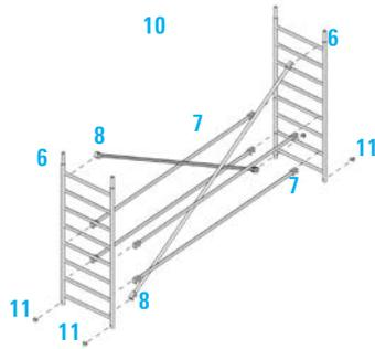
1. Es müssen beim Aufbau und Abbau Systembeläge oder Gerüstbohlen nach DIN 4420 (Mindestabmessung: 28 x 4,5 x 350 cm lang) als Hilfsbeläge im Höhenabstand von max. 2,0 m eingebaut werden. Diese Hilfsbeläge, als sichere Standfläche für den Auf- und Abbau, müssen nach dem Aufbau wieder ausgebaut werden. Die jeweilige Standfläche ist voll auszulegen.
