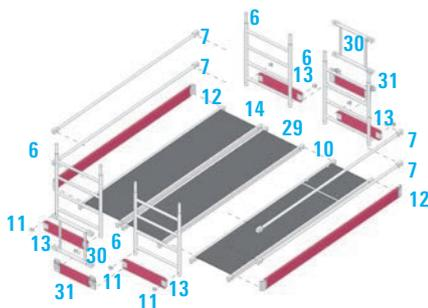
5. Der weitere Aufbau der Standleitern **6** sowie der Diagonalen **8**, Rückenlehne **7**, sowie Durchstiegsbrücken **10** erfolgt nach Abschnitt 2.3 bis Abschnitt 4.0 (s. Seiten 6 – 8). Es ist darauf zu achten, dass der Belag **14** mittig unter der Standleiter **6** liegt, maßgebend ist dabei die Standleiter **6**, die am Verstellteil des Fahrbalkens **26** steckt.
