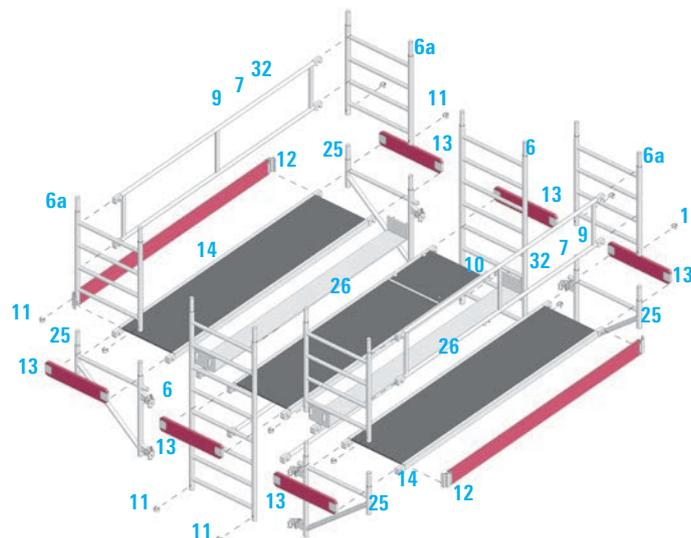
**3. Vor Anbau der Konsolen wird der Seitenschutz mit Bordbrettern an dieser Stelle demontiert.**
