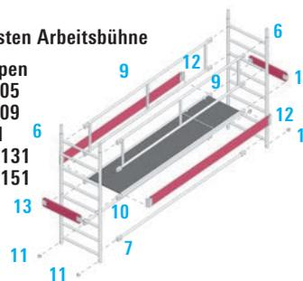
3. 2 Bordbretter 2,85 m 12 zwischen die Standleitern einstellen und durch Einfügen von 2 Stirnbordbrettern 0,75 m 13 sichern.
