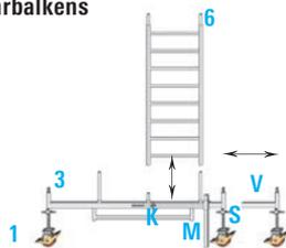
Der verstellbare Fahrbalken 3 ermöglicht das Arbeiten an der Wand. Er kann im aufgebauten Zustand ein- und ausgeschoben werden. Es ist zu beachten, dass vor dem Verstellen auf jeden Fall die in der Ballastierungstabelle angegebenen Ballastgewichte an der richtigen Stelle angebracht sind (siehe Seite 12). Zum Verstellen im aufgebauten Zustand wird die am Fahrbalken 3 angebrachte Mittelstütze (M) so weit wie möglich
