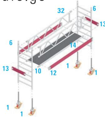
1. Die Lenkrollen **1** werden beim Gerüst 1201 in die Standleitern **6** eingesteckt und durch Festdrehen der Flügelschrauben an den Spindelmuttern gegen Herausfallen gesichert.
