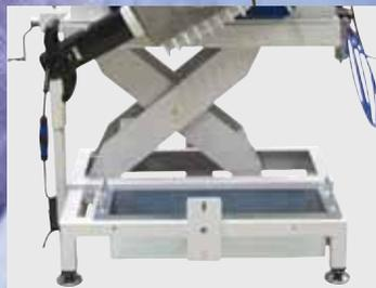
Inklusive höhenverstellbaren, robusten Hubtisch mit Späneauffangbehälter
