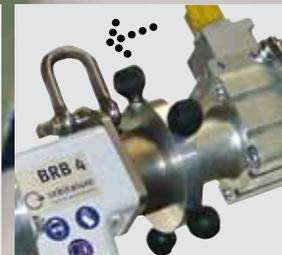
Halterung für Balancer ermöglicht ein schnelles und ermüdungsfreies Arbeiten.
