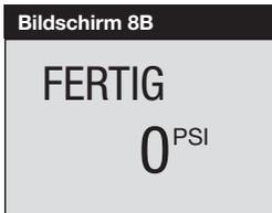
Der tatsächliche Systemdruck wird auf der Ziffernanzeige angezeigt, ganz gleich ob Automode AN oder AUS ist. Er bleibt bei „0“, bis der Pumpenmotor gestartet wird.
