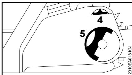
Beim Ansetzen des Kettenraddeckels müssen die Zähne von Spannrad und Spanscheibe ineinander greifen, ggf.
