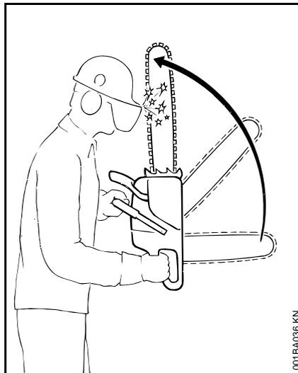
Bei einem Rückschlag (Kickback) wird die Säge plötzlich und unkontrollierbar zum Benutzer geschleudert.
