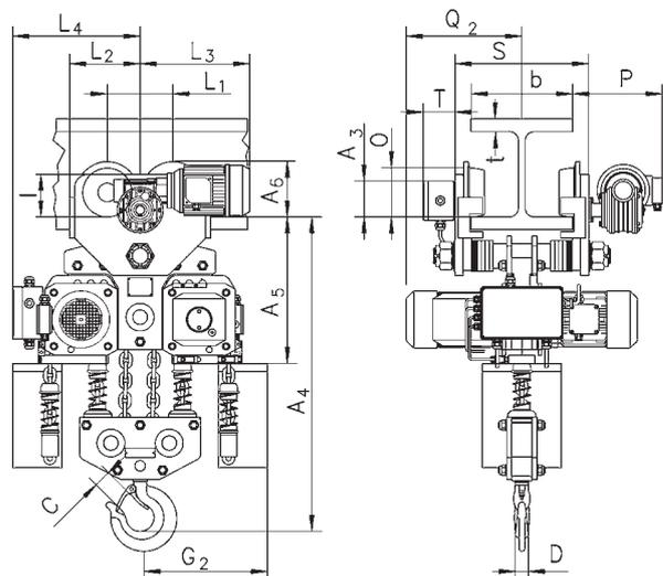
Modell CPE/CPEF Festverbindung mit Elektrofahwerk, 10.000 kg
