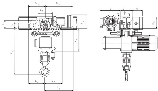
Modell CPE/CPEF Festverbindung mit Elektrofahwerk
