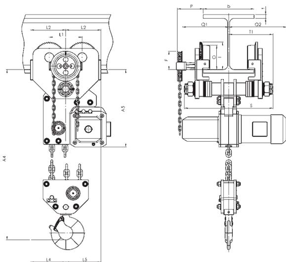
Modell CPE/CPEF Festverbindung mit Haspel- oder Elektrofahwerk, 7.500 kg
