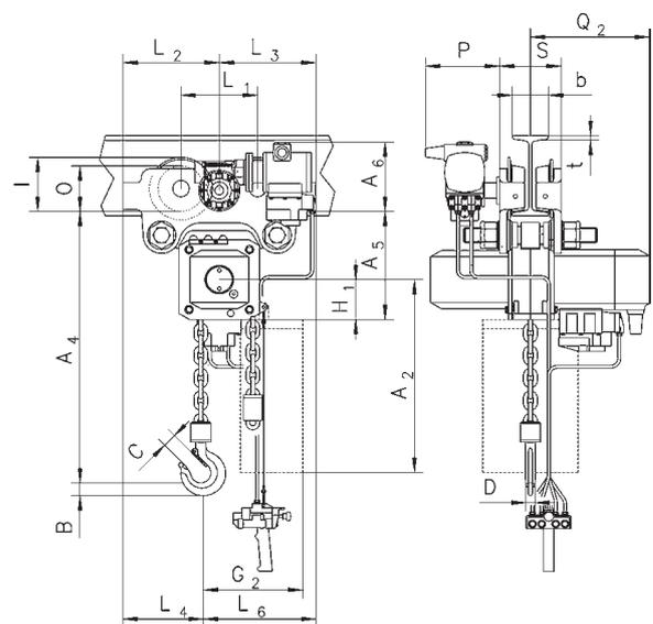
Modell CPA Festverbindung mit Druckluftfahwerk
