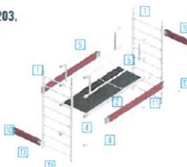
Die Standleiter (1) werden aufgesteckt und mit Federsteckern (13) gesichert. In die Standleiter (1) wird in die 5. Sprosse von oben die Durchstiegsbrücke (2) eingehängt. Dann wird der Seitenschutz mit 2 Doppelryckenlehnen (3) hergestellt. Als nächstes werden 2 Bordbretter 1,8 m (11) zwischen den Standleitern (1) eingestellt und durch das Einfügen von 2 Stirnbordbrettern 0,75 m (12) ausgestellt.
