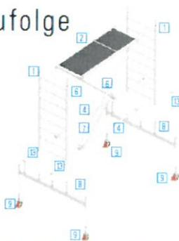
Die Lenkrollen (9) in die Fahrbaiken (8) einstecken und durch Schrauben M 12x60 mit selbstsichernden Muttern befestigen. Auf die Fahrbaiken (8) sind nun die Standleiter (1) aufzustecken und mit Federsteckern (13) zu sichern. Nun werden 2 Diagonalen (5) in die Standleiter (1) eingerastet. Dann sind in der 1. Sprosse von unten der Standleiter (1) 2 Rückenlehnen (4) und ab dem Typ 3204 1 Horizontal-diagonale (7) einzurasten.
