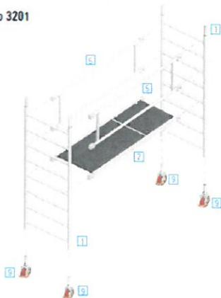
Die Lenkrollen [7] in die Standleitern [1] einstecken und durch Schrauben M 12x60 mit selbstsichernden Muttern befestigen. Die beiden Standleitern [1] durch 2 Doppelrückenlehnen [3] verbinden und damit aussteifen. Die Durchstiegsbrücke [2] ist in die von unten 4. Sprosse einzuhängen. Die Einrastklauen aller Teile sind dabei von oben her in die Standleitersprossen [1] einzurasten.
