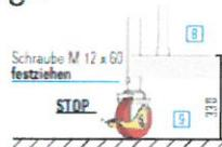
Die Lenkrollen [2] sind im Aufbau und Arbeitszustand durch Drücken des mit STOP gekennzeichneten Bremshebels festzustellen. Im gebremsten Zustand
