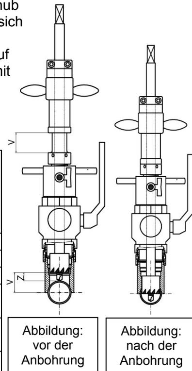
Mit Betätigung der Knarre, bzw. des Motors (Drehrichtung im Uhrzeigersinn), und vorsichtiger Vorschubzustellung über die Ballengriffe wird die Bohrung durchgeführt. Bei Anbohrungen den Vorschub langsam und gleichmäßig zustellen, um Werkzeugbruch und auch das Umschlagen eines evt. eingesetzten Motors zu verhindern!
