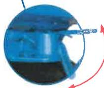
Automatische Sicherung der Zugöse. Durch einen Federmechanismus wird die Deichsel gegen ein ungewolltes Lösen gesichert.
