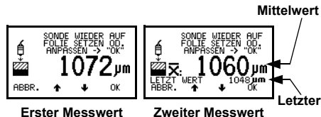
Abb. 31. Schritt 1 - Kalibrier-Anpassung auf Dickenstandard
