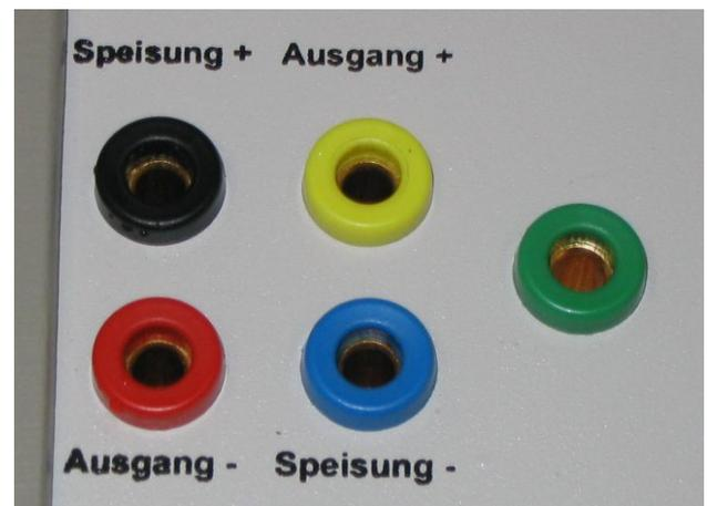
Die Speisung der DMS-Brücke der Kraftmessdose erfolgt über die Bananenstecker schwarz und blau. Das Ausgangssignal der Kraftmessdose wird über die Bananenstecker gelb und rot in das Kraftmessdosenanzeigegerät eingespeist. Mit dem grünen Bananenstecker wird der Kabelschirm mit dem Messgerät verbunden, der auch mit dem Kraftmessdosengehäuse verbunden ist.
