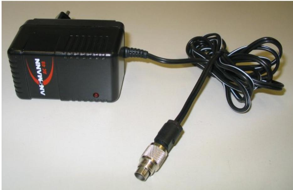
Sollte das Kraftmessdosen-Anzeigegerät einen Doppelpunkt in der Mitte des LC-Displays anzeigen, so ist der Ladezustand des internen Akkumulators zu niedrig. In diesem Fall schließen Sie das mitgelieferte Ladegerät an die Ladebuchse an. Nach ca. 11 Stunden ist der Akkumulator zu 100 % geladen.
