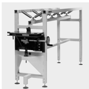
Рольганг (с установленным на нём монтажным блоком для крепления и позиционирования трубореза) (код 790 068 051)
