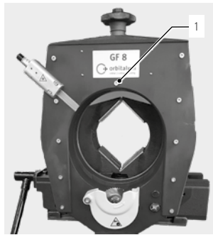
Position der Sicherungsschraube (1) bei der GF 8, GF 12 (AVM/MVM).
