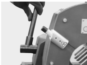
Крепление зажимных кулачков (только для GF 4 (AVM/MVM))
