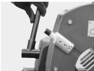
Spanbekken verwisselen (bij de GF 4 (AVM/MVM))
