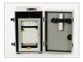
Schreibbreiten / Vorschübe Einfach-LBS 100 mm (standard) Zweifach-LBS 2 x 100 mm (standard) (optinal 120 mm bzw. 2x 120mm) Dreifach-LBS 3 x 80 mm Standard 20mm/h mechanisch 5 bis 1200 mm/h elektrisch 20 bis 3600 mm/h
