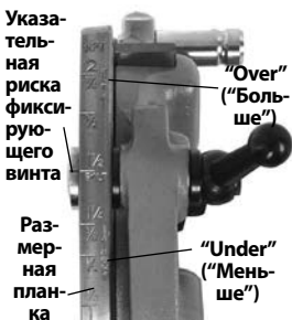
Рис. 13 – Настройка размера резьбы
