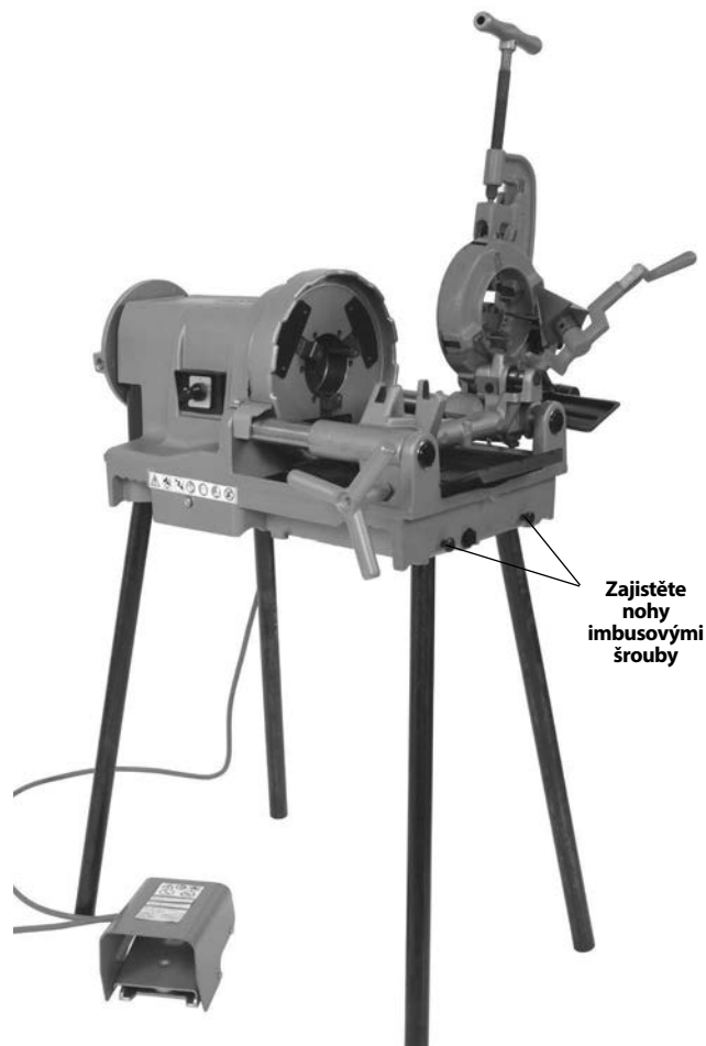
Obrázek 4 – Závitorezný nástroj namontovaný na trubkových nohách
