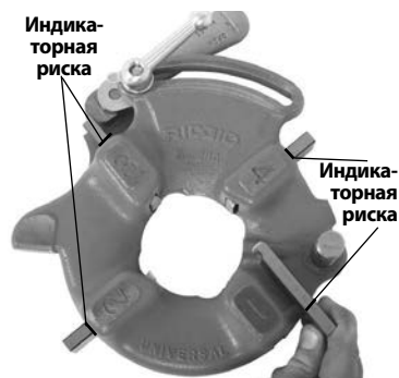
Рис. 8 – Вставка резьбонарезных гребенок
