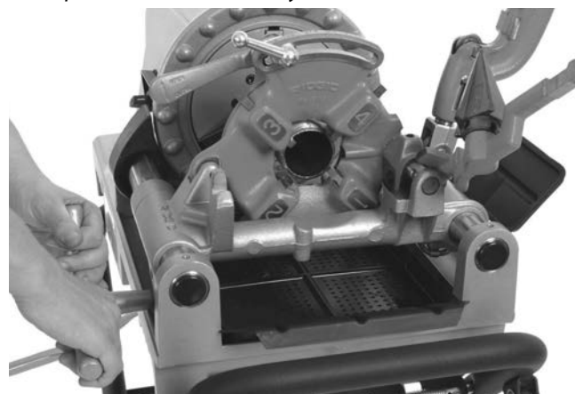
Obrázek 24 – Řezání závitu trubky (je zobrazena rychle otevírací závitorezná hlava 811-A)
