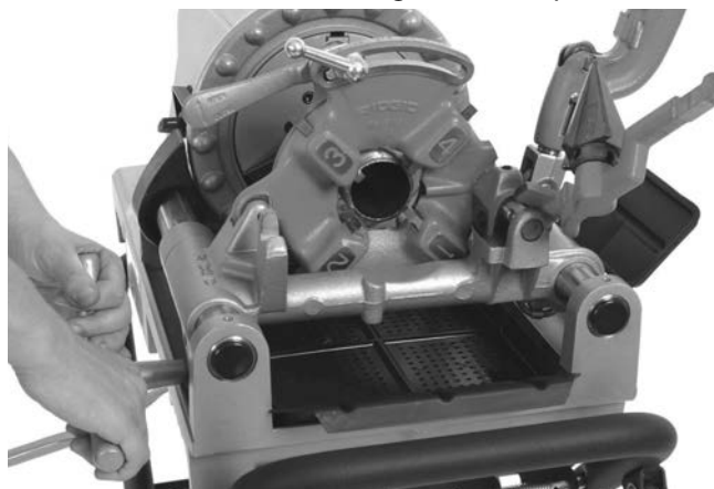
Figura 24 – Filettatura del tubo (Testa portapettini ad apertura rapida 811-A mostrata)
