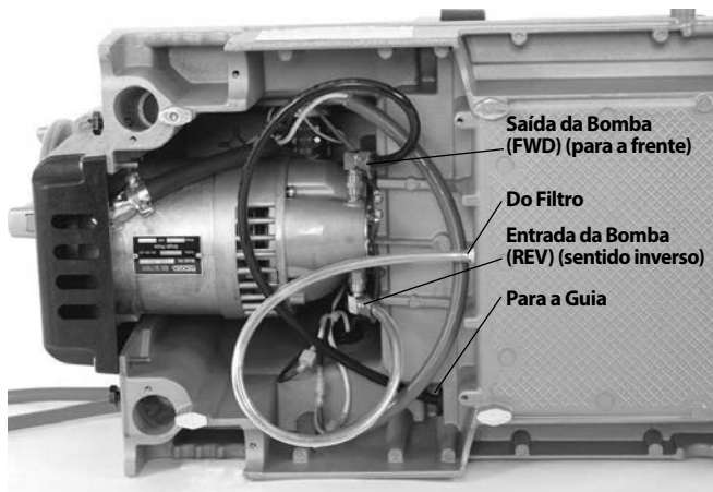
Figura 25B – Ligações da Bomba de Óleo para Roscagem Manual do Lado Direito (Interruptor em FWD (para a frente))
