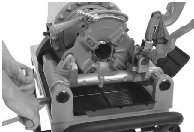
Kuva 24 – Putken kierteitys (kuvassa pika-aukeava kierrepää 811-A)
