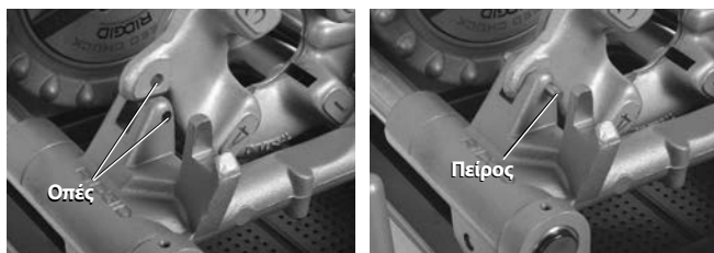
Εικόνα 26 – Διατήρηση φιλιέρας αριστερού σπειρώματος στη θέση της
