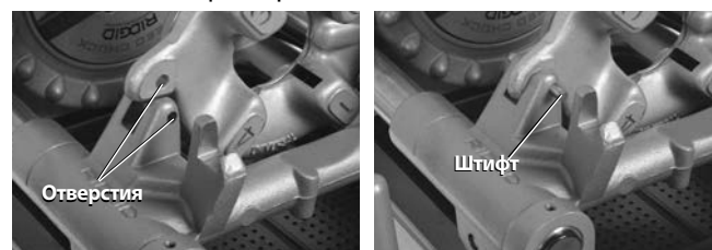
Рис. 26 – Фиксация левой резьбонарезной головки на месте
