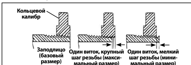
Рис. 27 – Проверка размера резьбы
