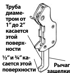
Рис. 14 – Регулировка положения защелки
