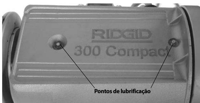
Figura 29 – Pontos de Lubrificação
