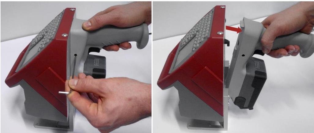
3. Die 4 Befestigungs-Schrauben am Stellwinkel lösen (Innensechskant-Schlüssel SW 3 mm erforderlich).
