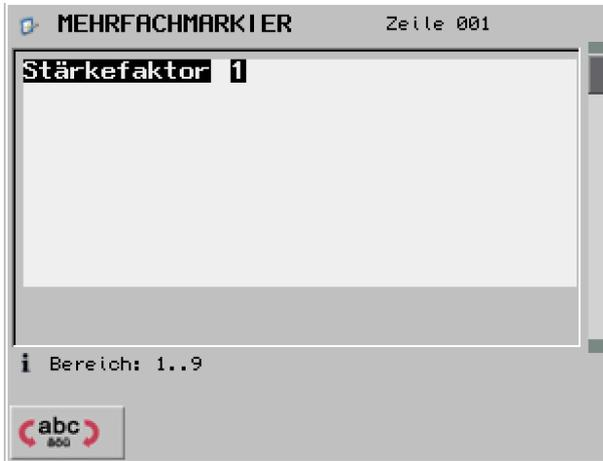
Der Stärkefaktor gibt an, wie oft ein Markierpunkt geschlagen wird. Durch eine Mehrfachmarkierung wird die Markierung intensiver. Die Markierzeit erhöht sich entsprechend.
