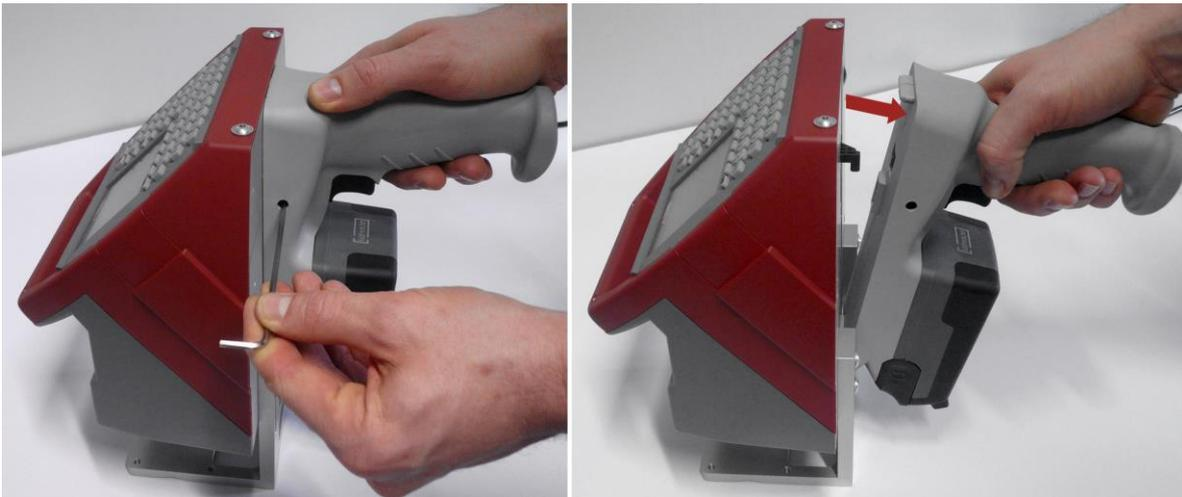
2. FlyMarker® PRO am Träger einhängen und mit 2 Rändel-Schrauben befestigen.
