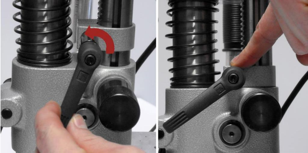
9. Fühlerlehre (Dicke 2 - 4 mm) zwischen Markiernadel und Werkstück legen und mit dem Startgriff die Markiernadel bis zur Einstellhilfe bewegen und halten.
