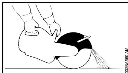
Schutz für die Trennschleifscheibe richtig einstellen: Werkstoffpartikel von Benutzer und Gerät weg lenken.
