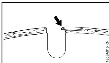
Wird mit stumpfen Segmenten weitergearbeitet, können diese wegen der hohen Hitzeentwicklung weich werden – das Stammblatt glüht aus und verliert seine Festigkeit – dies kann zu Verspannungen führen, deutlich erkennbar an Taumelbewegungen der Trennschleifscheibe. Die Trennschleifscheibe nicht weiter verwenden – **Unfallgefahr!**
