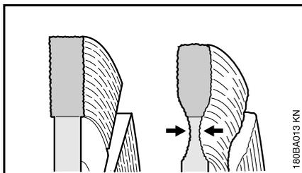
Beim Trennen von Fahrbahndecken nicht in die Tragschicht (häufig Schotter) eindringen – Trennschleifen im Schotter ist am hellen Staub zu erkennen – dabei kann übermäßiger Kernverschleiß auftreten – **Bruchgefahr!**
