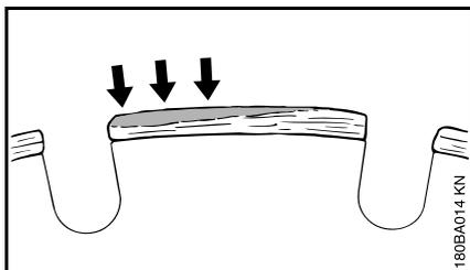
Aufbauschneiden bilden sich als hellgrauer Belag an den Oberseiten der Diamantsegmente. Dieser Belag setzt die Diamanten in den Segmenten zu und stumpft die Segmente ab.
