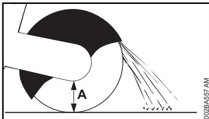
Die Vorgehensweise ist abhängig vom Außendurchmesser des Rohres und der maximal möglichen Schnitttiefe der Trennschleifscheibe (A).
