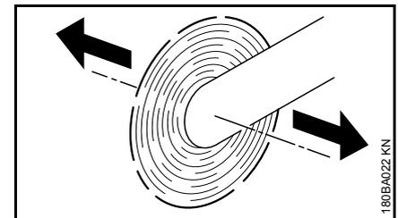
Wird ein Trennschleifer mit einer rotierenden Trennschleifscheibe in Pfeilrichtung bewegt, entsteht eine Kraft, die das Gerät zu kippen versucht.
