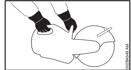
Motorgerät immer **mit beiden Händen festhalten**: Rechte Hand am hinteren Handgriff – auch bei Linkshändern. Zur sicheren Führung Griffrohr und Handgriff mit den Daumen fest umfassen.
