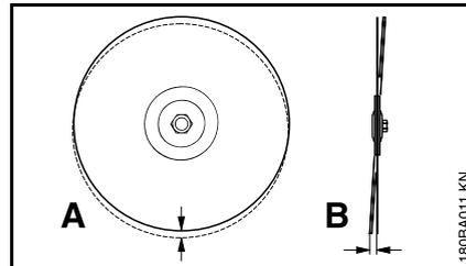
Eine zu große Rundlaufabweichung (A) überlastet einzelne Diamantsegmente, die sich dabei erhitzen. Dies kann zu Spannungsrissen im Stammblatt oder zum Ausglühen einzelner Segmente führen.
