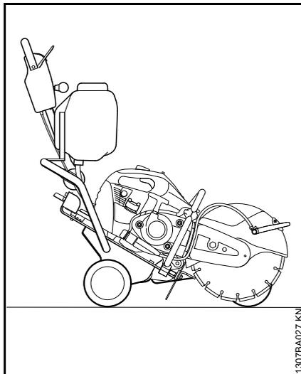
Der Trennschleifer kann mit wenigen Handgriffen auf dem STIHL Führungswagen FW 20 (Sonderzubehör) montiert werden.
