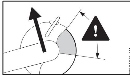
Bei einem Rückschlag (Kickback) wird der Trennschleifer plötzlich und unkontrollierbar zum Benutzer geschleudert.
