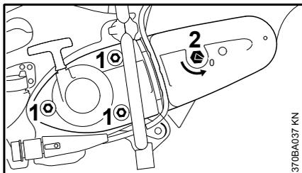
Vor dem Spannen des Keilrippenriemens müssen die Muttern (1) gelöst sein und der Pfeil auf der Spannmutter (2) muss auf 0 weisen.
