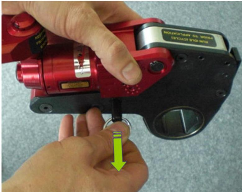
Die Hydraulik-Einheit des Werkzeuges am hinteren Teil anheben und heraus ziehen.
