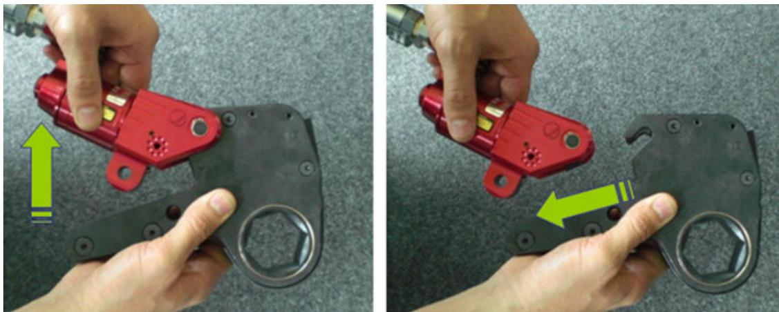
Zusammensetzen in umgekehrter Reihenfolge. Vor dem nächsten Einsatz an die Hydraulik-Pumpe anschließen und einige Kontroll-Hübe bzw. Leerhübe durchführen. Dies dient dazu, den Kolbstangen-Haken des Hydraulik-Kopfes in die Kassette einzuhaken. Erst jetzt ist das Werkzeug korrekt zusammengesetzt und einsatzbereit.
