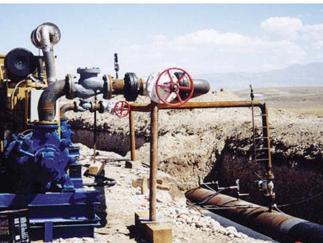
Prüfpumpenaggregat DP3-10 E mit Direktantrieb auf Industriefahrgestell
