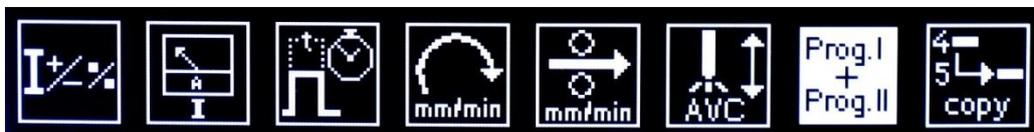
Hier kann über die Taste **F7** zwischen den zwei verknüpften Programmen gesprungen werden um die Schweißparameteranpassung vorzunehmen und die Überlappung auf 6 Uhr in Winkelgraden einzustellen. Empfehlenswerte Überlappung 10°
