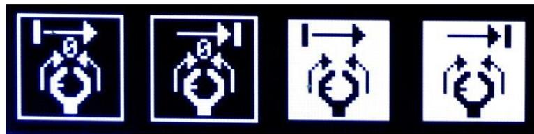
Bei **RBK**-Schweißköpfen bzw. **TURN**-Drehvorrichtungen ist in der Grundeinstellung keine dieser Home-Funktion aktiv. Wenn bei diesen Schweißwerkzeugen ein Anfahren der **Start-Position** erwünscht ist bitte **F4** aktivieren.
