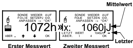
Abb. 31. Schritt 1 - Kalibrier-Anpassung auf Dickenstandard
