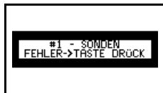
Abb. 58. Beispiel Fehlermeldung - es ist keine Sonde an das Messgerät angeschlossen
