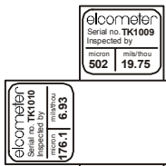
Abb. 29. Übereinanderlegen von Folien zum Erhöhen der Dicke
