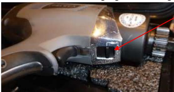
Umschalten zwischen schrauben mit Drehmoment > **TORQUE**
