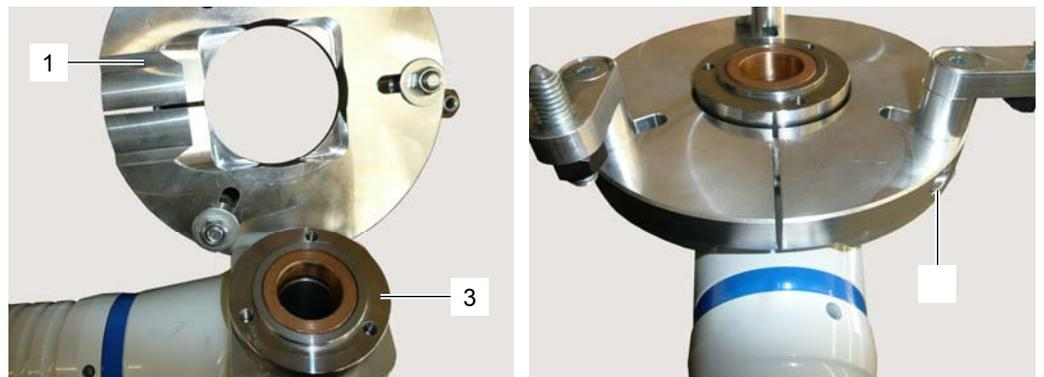
4. Werkzeugaufnahme wieder montieren.
