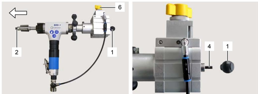
4. Spannkeilaufnahme (3) mit Hilfe der Gewindespindel (4) nach außen bis zum Mastende verschieben.
