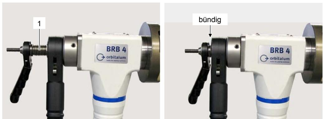
2. BRB in das Rohr einsetzen.
