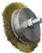
Die neuen Bürstenaufsätze aus Messing verhindern das unbeabsichtigte Hereinfallen von Spänen und anderen Fremdkörpern in das Rohrrinnere. Vor allem beim vertikalen Arbeiten an Behältern ist dieser Aufsatz sehr nützlich. Die Bürsten können auf die Gewindespindel der neuen BRB schnell und einfach montiert werden. Für BRB-Maschinen bis Baujahr 10/2009 kann eine neue Gewindespindel nachgerüstet werden (siehe Kap. 2.8.6, S. 18). Alle Bürsten sind für beide Spannsysteme (Standard/NC) einsetzbar.
