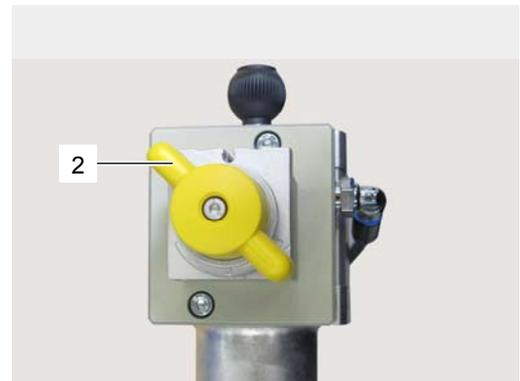
3. Druckluft anschließen und auf Mindestdruck (6 bar) überprüfen.
