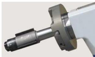
Das neue Spannsystem "NC" ist mit seinen im Mast fest verankerten Spannkeilen ideal für Anwendungen, bei denen keine Fremdkörper ins Rohrrinnere oder einen Behälter gelangen dürfen. Besonders bei vertikalen Arbeiten gibt das Spannsystem "NC" zusätzlich Sicherheit. Die Spannkeile können schnell ausgetauscht werden.
