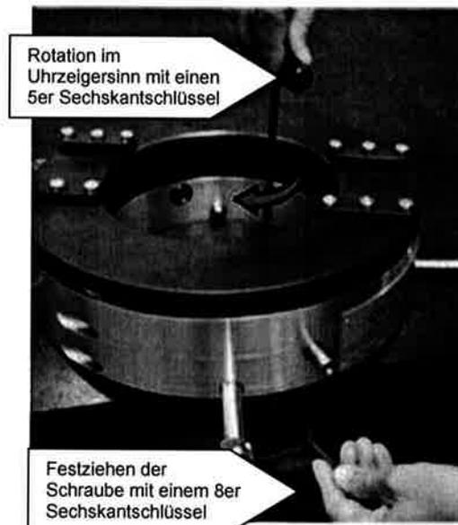
Durch die Werkzeughalterplatte einen Sechskantschlüssel SW5 in die einzustellende Lagerrolle einstecken (durch die Gewinde der Sicherungsschrauben).
