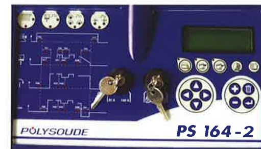
Synoptische Benutzeroberfläche einer Polysoude Orbitalschweißstromquelle PS 164-2
