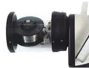
Integrierte Drahtvorschubeinheit bei einem Polysoude Schweißkopf TS 8/75
