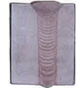
Makrographisches Schlibfbild einer Engspaltschweißnaht
