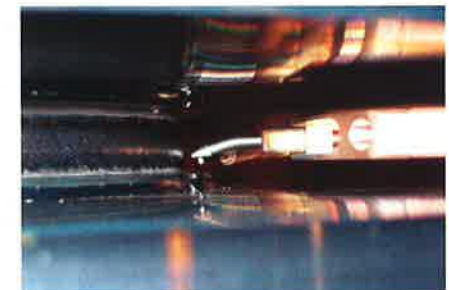
Abb. 24: Einbringen von mehreren schleppend geschweißten Raupen pro Lage mit Elektroden mit abgewinkelter Spitze
