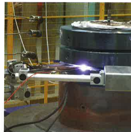
Abb. 13: WIG-Engspaltbrenner NG-7 mit Führungsvorrichtung zum automatischen Zentrieren in der Schweißfuge
