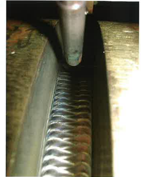
Abb.26: Gependelt eingebrachte Schweißlage
