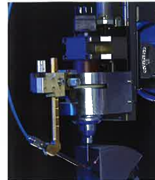
Abb.19: WIG-Brenner mit motorisch verstellbarer Schutzgasdüse. Bei diesen WIG-Brennern entfällt das sonst notwendige manuelle Nachstellen des Elektrodenüberstandes.
