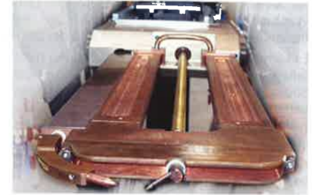
Abb.16: Engspaltbrenner des Typs NG-OSC mit gependelter Elektrode. Die Elektrode ist auf einer drehbaren Schweißblanze befestigt und wird durch den Brennerkörper geführt (isoliert). Die Pendelung der Drahtführung kann durch einen zweiten Antriebsmotor erzeugt oder durch ein Getriebe aus Zahnrädern und Hebeln übertragen werden. Es handelt sich dabei immer um Bewegungen auf einer Kreisbahn. Die Pendelweiten sind einstellbar, die Drahtbewegung kann unabhängig reguliert werden.
