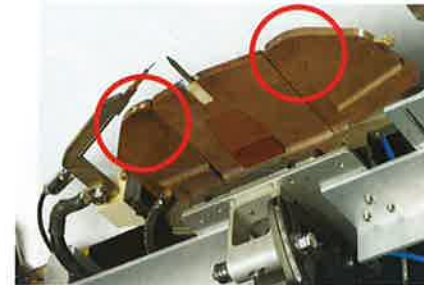
Abb. 18: Montage von Videokameras bei WIG-Engspaltbrennern der Typen V2 und V3
