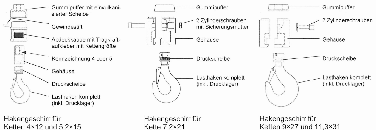
Bild 4: Aufbau der Hakengeschrirre
