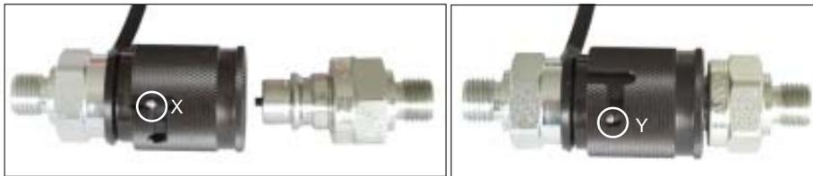
Vor dem Kuppeln Verriegelungshülse der Muffe (Position X) zurückziehen und halten. Nippel und Muffe zusammenstecken und die Verriegelungshülse loslassen. Abschließend die Verriegelungshülse in Position Y drehen.
