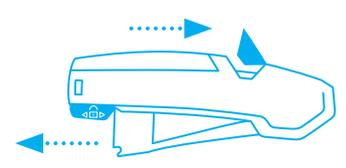
Schieben Sie die Sicherung in die hintere Position, damit sich der **Hebel wieder lösen** kann. **Danach** Klingenwechselknopf in den Griff zurückdrücken und weiterschneiden.
