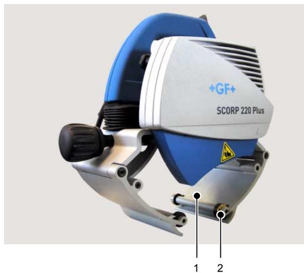
Die Anpassung gilt jeweils nur für die aktuelle Rohrgröße, das Rad muss neu eingestellt werden, sobald das Sägeblatt abgenutzt ist.
