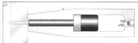
Die Energie der Treibladung wird auf einen Kolben übertragen, dessen beschleunigte Masse den Nagel in den Untergrund eintreibt. Da rund 95 Prozent der kinetischen Energie im Kolben verbleiben, dringt das Befestigungselement mit einer stark verminderten Geschwindigkeit von weniger als 100 m/Sek. kontrolliert in den Untergrund ein. Das Abstoppen des Kolbens im Gerät beendet zugleich den Setzvorgang, und so sind bei korrekter Anwendung gefährliche Durchschüsse praktisch unmöglich.
