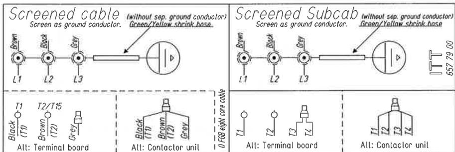
50/60 Hz, 3-phasig, mit Schütz, Sternreihen- oder -parallelschaltung, mit oder ohne Transformatorbetrieb
