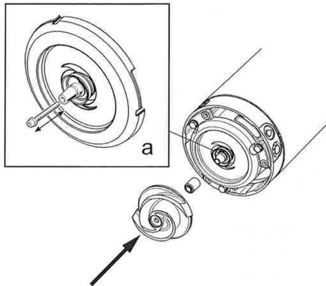
6. Montieren Sie das Diffusorbauteil und ziehen Sie dieses fest.
