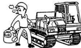
NICHT RAUCHEN BEIM KRAFTSTOFF-AUFFÜLLEN
