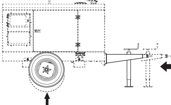
Führen Sie die Montage des Stromerzeugers auf das Fahrgestell CTL 20 wie folgt durch:
