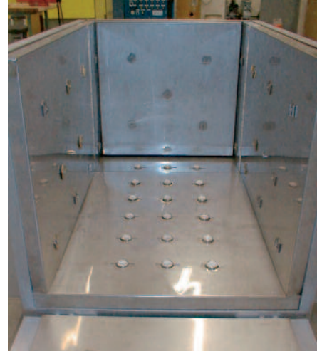
Vorwärm- und Glühboxen für das Vorwärmen und das Spannungsarmglühen von Werkzeug- und Gesenkschmiedeteilen
