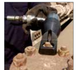
Muttersprenger Modell YNS/YNS-AH, SW 11-89 mm
