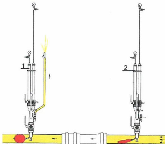
**IV. Beispiel** - Einbindung oder Reparatur zwischen zwei Blasensetzgeräten (Ringleitung)
