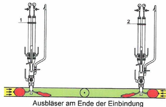
**HINWEIS** Beim Einsatz von Stoffblasen ist ein Druckausgleich nicht unbedingt erforderlich, jedoch schonender für die Blase. Bei der Stoffblase sind die möglichen Sperrdrücke in Bezug zur Sperrdimension wesentlich geringer und die Stoffblase verschließt das Rohr nicht 100 % dicht. Durch die Leckgasmengen (bedingt durch die Stoffhülle) wird sich nach Schließen des ¾"-Kugelhahnes am Setzdom, mehr oder weniger schnell, ein automatischer Druckausgleich einstellen.
