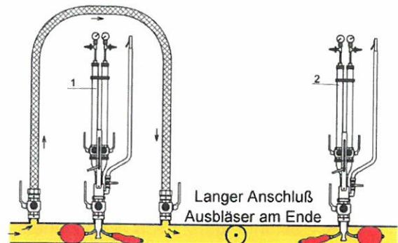
**V. Beispiel** – Einbindung oder Reparatur zwischen 2 Blasensetzgeräten (Ringleitung)
