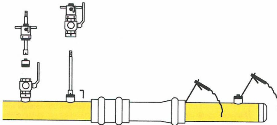
Die Einheit auf den 2 ½" Kugelhahn aufschrauben und den Hahn öffnen. Die Stopfenstange nach unten schieben und den Stopfen in die Muffe / Schelle einschrauben. An dem ¼" Kugelhahn des Anbohrdomes prüfen, ob der Stopfen dicht ist. Demontage der Stopfensetzeinheit samt Schleuse und Adapter.
