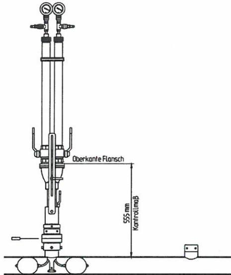
Beim Einsatz der Blasensetztechnik auf einer Spannkopfaufnahme Ø 80 mm, anstatt einer Gewindemuffe oder Blasensetzschelle, muß ein abweichender Aufbau verwendet werden.
