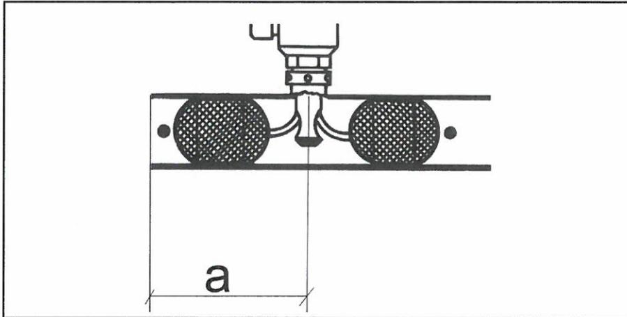
Der mindest Sicherheitsabstand **a** bezieht sich von der Gerätemitte bis zum Schnitt. Hierbei kann die Blase durch das Trennen nicht beschädigt werden.
