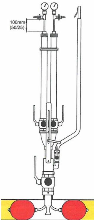
Die Blase wird nach dem Vorbiegen von Hand an das Gestänge geschraubt, mit der Blasenpumpe (Saugventil) vakuum gezogen und der ¼“ Kugelhahn am Gestänge geschlossen. Hierdurch läßt sich das Teleskop in der Blase nicht mehr zusammen schieben und die Blase wird zum Setzen schlank.
