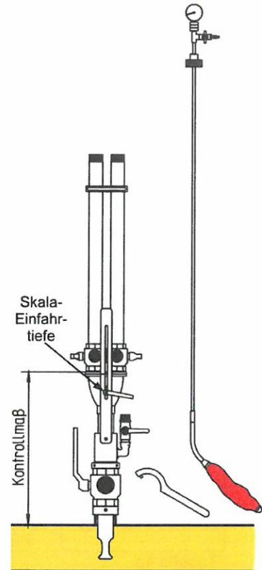
Damit die Blase beim Einsatz im Gerät problemlos von der Senkrechten in die Rohrachse umlenkt, muß die Blase vorgebogen werden. Die **MDS-Blase** wird im Teleskoprohr-Bereich und im Füllschlauch-Bereich vorgebogen, so dass die Blase eine Vorbiegung von 90° erhält. (Achtung: Biegen - nicht knicken.)
