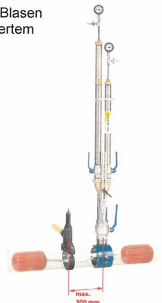
**HINWEIS** Bei der MDS-Blase mit längerem Füllschlauch ist es von Vorteil die möglichst größte Blasendimension zu wählen. Hierdurch hat die Blase eine längere Anlagefläche im Rohr und zentriert sich hierdurch besser.
