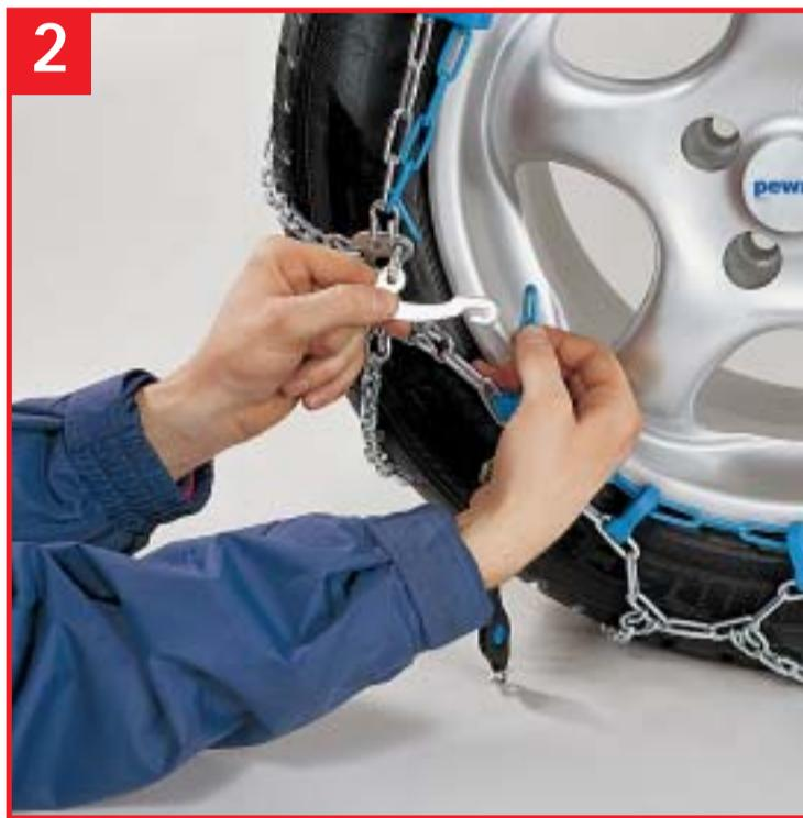
D Spannhebel öffnen und Kette lockern.
