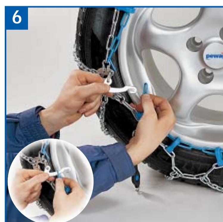
D Auf der Radaussenseite blaue Spannkette anziehen und den Spannhebel in das nächste erreichbare Glied der Spannkette einführen.
