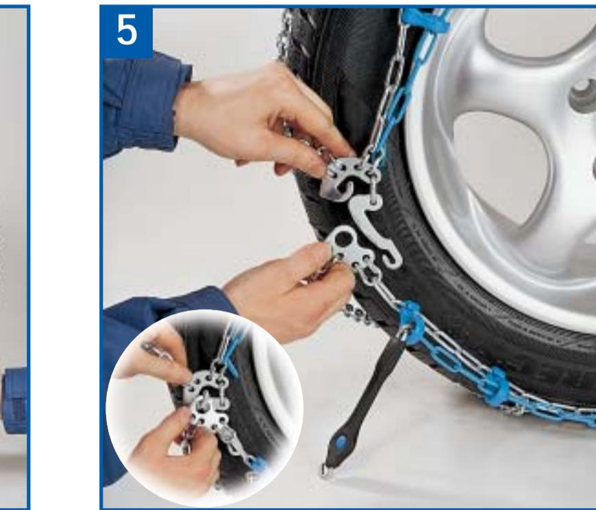
D Haken und Öse an der Radaussenseite zusammenhangen.
