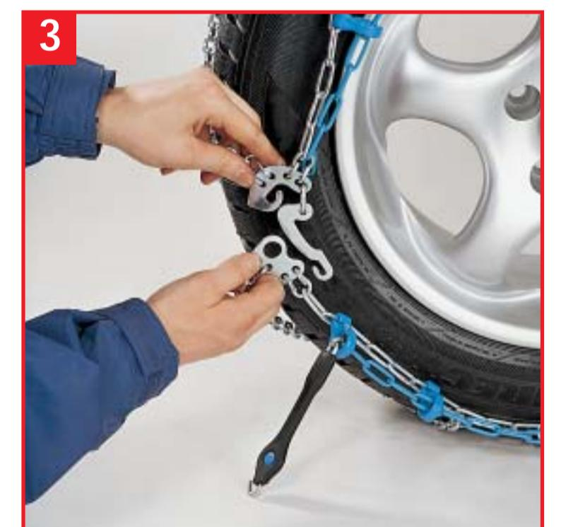
D Aussen und innen Haken aushängen und die Kette vom Reifen herunterziehen. Danach mit dem Rad von der Kette fahren.
