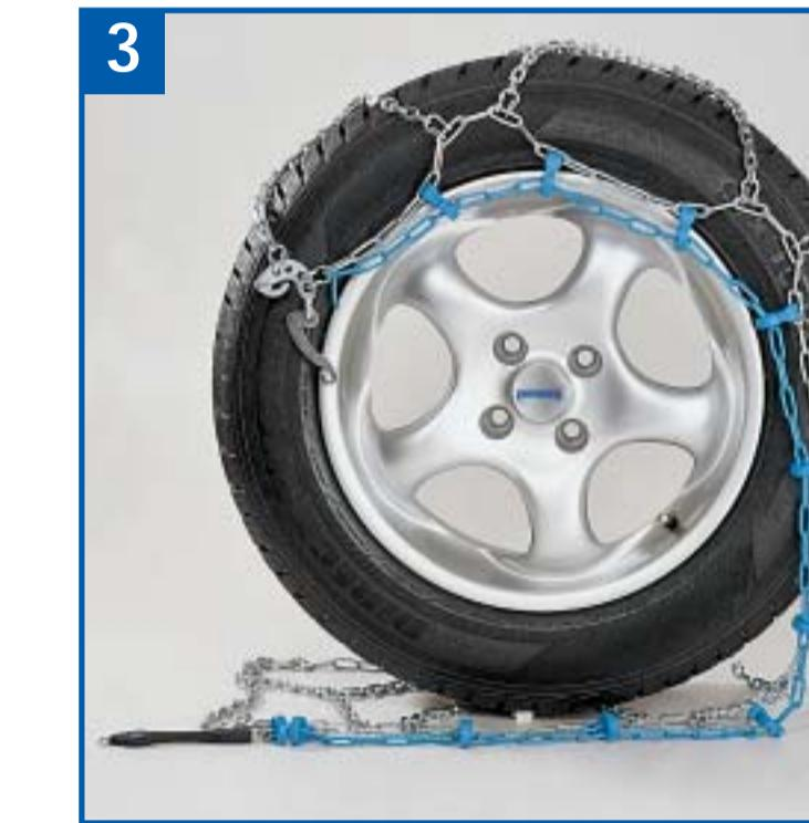
D Ca. 1/4 Radumdrehung auf die Kette auffahren (bei Steigung – wenn möglich – bergab auffahren).
