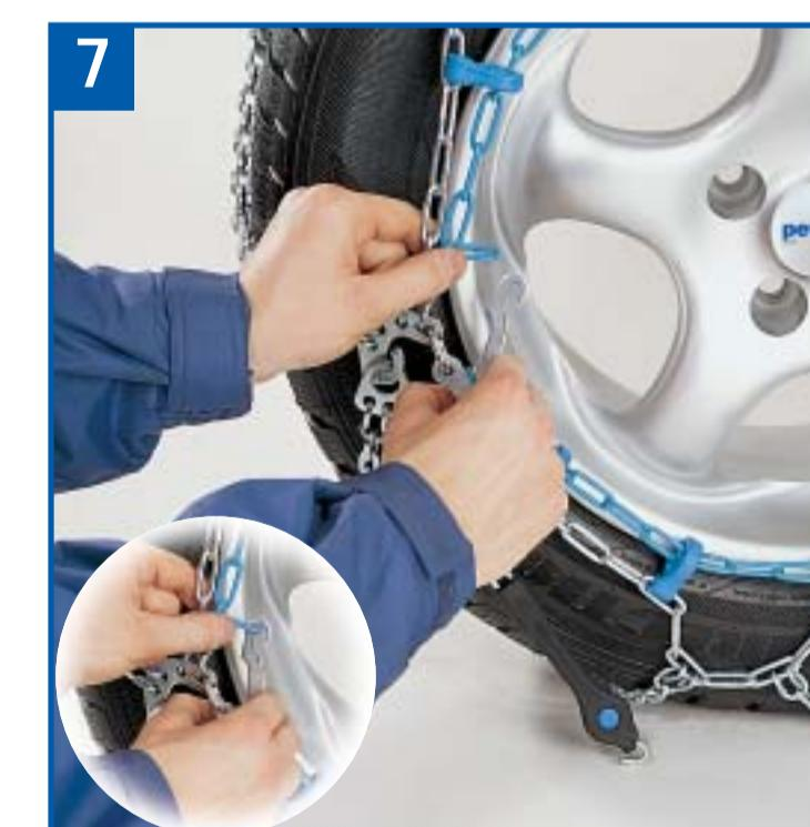
D Spannhebel mit Rückhängeglied sichern.
