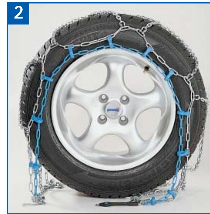
D Die Kette gleichmäßig am Reifen verteilen und ein Kettenende soweit wie möglich unter den Reifen schieben.
