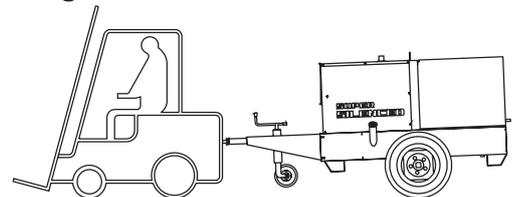
Diese Art Fahrgestell wird an den Grundrahmen des Aggregates angeschraubt. Es ist nicht für öffentlichen Strassen vorgesehen und darf nur auf begrenztem privaten Grund verwendet werden zugelassen.
