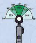
Beispiel: Tragfähigkeit in % bei Typ Shark S mit Schwenköse bei Querzug.
