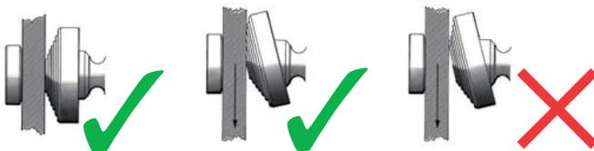
Durch Anziehen der Spindel mit normaler Handkraft wird die Gegennocke sicher am zu hebenden Gut angedrückt.
